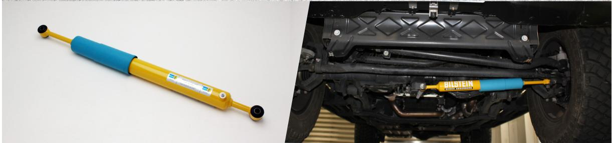
純正品とは異なる減衰プロファイルを採用することにより、ステアリング中立付近のしっとり感と直進時の安定性を確保。
